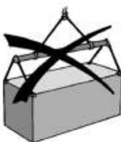
Пример подъема контейнера за четыре крепления в нижних углах
