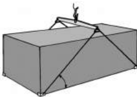
Пример подъема контейнера за четыре крепления в нижних углах
