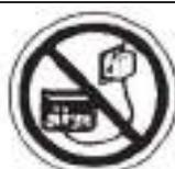
Бензин является легко воспламеняемым и взрывчатым веществом. Осуществляйте заправку электростанции топливом только в хорошо проветриваемых зонах при выключенном и остывшем двигателе. Поблизости не должно быть курящих, источника искр и дыма. Всегда заправляйте электростанцию в хорошо проветриваемом месте. Пролитый бензин необходимо сразу удалить.
