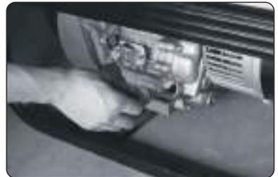
(b) Установите на место спускную пробку и залейте масло до верхней отметки по уровню крышки масляного бака.
