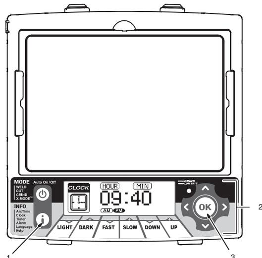
**Таймер (Timer)** активирует звуковой сигнал и мигание индикатора режима шлифовки, чтобы предупредить сварщика об окончании определенного периода времени.
